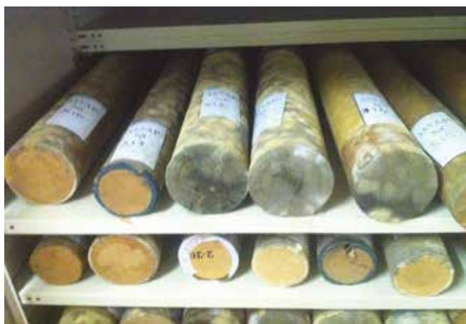
Tubes en carton contenant des plans d'architectes avec des moisissures.
