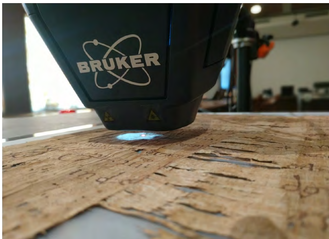
Photographie d'un papyrus à l'aide de microscopes ultraviolet et infrarouge, afin d'étudier fibres et encres © Archives nationales de France
