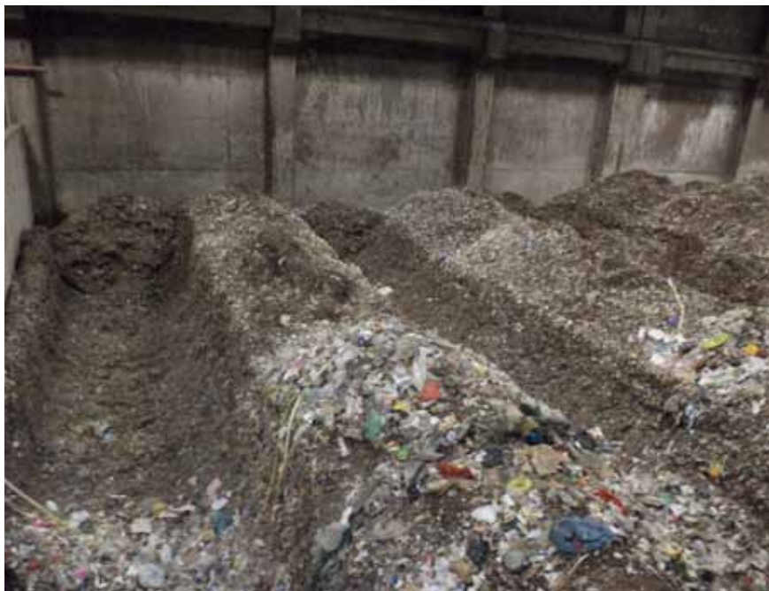
Slika 2: Hala za biostabilizacijo MKO
