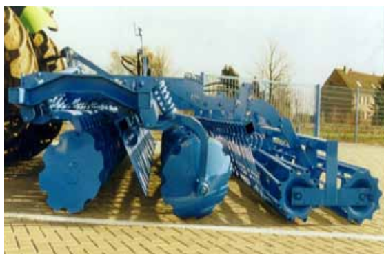
Slika 3: Diskasti rahljalnik z zgoščevalnimi valji
