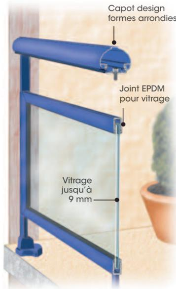
Garde-corps posé sur dalle avec vitrage
