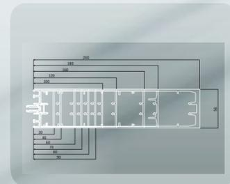
La structure est composée de montants et traverses de 56mm de large, dont les sections (profondeurs) varient de 30mm à 240mm, en fonction des inerties nécessaires. Un seul et même type de profil peut être utilisé en guise de montant et de traverse.
