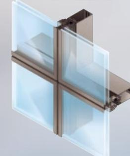
L'aspect VEP est obtenu par la mise en place de cadres à rupture de pont thermique recevant une pareclose extérieure en aluminium qui assure la tenue des vitrages. Ces cadres sont assemblés en coupe d'onglet par le biais d'équerres à pion ou d'équerres à sertir.
