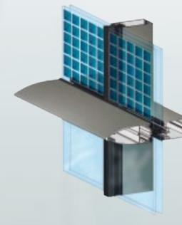
La mise en place de capots horizontaux et d'un joint vertical bidreté à l'extérieur, permet d'obtenir l'aspect trame horizontale. Le capot horizontal est clippé sur un serreur en aluminium qui assure la tenue des vitrages.
