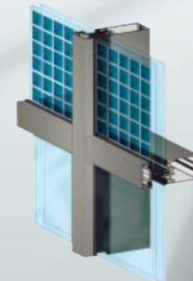
L'aspect grille est obtenu par la mise en place de capots horizontaux et verticaux à l'extérieur. Ces derniers sont clippés sur un serreur en aluminium qui assure la tenue des vitrages.
