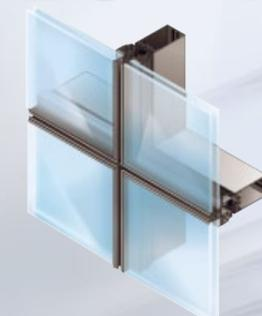
L'aspect VEC est obtenu par la mise en place de cadres avec vitrages non bordés ne laissant pas apparaître de structure aluminium à l'extérieur. Ils sont assemblés en coupe d'onglet par le biais d'équerres à pion ou d'équerres à sertir.
