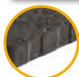
Les pavés sont équipés de **distanciers plats** afin de faciliter la réalisation de joints en conformité avec la réglementation en vigueur. La mise en oeuvre des pavés doit être réalisée conformément à la norme NF P 98-335, sur sable ou mortier. Les joints sont obligatoires au sable stabilisé, mortier Fabjoint ou mortier traditionnel.
