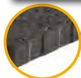
Les pavés sont équipés de **distanceurs plats** afin de faciliter la réalisation de joints en conformité avec la réglementation en vigueur. La mise en oeuvre des pavés doit être réalisée conformément à la norme NF P 98-335, sur sable ou mortier. Les joints sont obligatoires au sable stabilisé, mortier Fabjoint ou mortier traditionnel.
