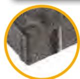
Les pavés sont équipés de **distanceurs crayons** afin de faciliter la réalisation de joints en conformité avec la réglementation en vigueur. La mise en oeuvre des pavés doit être réalisée conformément à la norme NF P 98-335, sur sable ou mortier. Les joints sont obligatoires au sable stabilisé, mortier Fabjoint ou mortier traditionnel.
