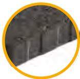
Les pavés sont équipés de **distanceurs plats** afin de faciliter la réalisation de joints en conformité avec la réglementation en vigueur. La mise en oeuvre des pavés doit être réalisée conformément à la norme NF P 98-335, sur sable ou mortier. Les joints sont obligatoires au sable stabilisé, mortier Fabjoint ou mortier traditionnel.
