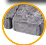
Les pavés sont équipés de **distanciers** afin de faciliter la réalisation de joints en conformité avec la réglementation en vigueur. La mise en oeuvre des pavés doit être réalisée conformément à la norme NF P 98-335, sur sable ou mortier. Les joints sont obligatoires au sable stabilisé, mortier Fabjoint ou mortier traditionnel.
