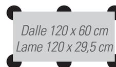
La mise en œuvre d'une dalle céramique 60 x 60 cm nécessite 4 plots (1 par angle), 75 x 75 cm nécessite 5 plots (1 par angle + 1 central en sous face), pour une dalle 120 x 60 cm ou la lame 120 x 29,5 cm, il est nécessaire de positionner 6 plots (1 par angle + 1 plot à mi-distance sur chaque longueur de la dalle).
