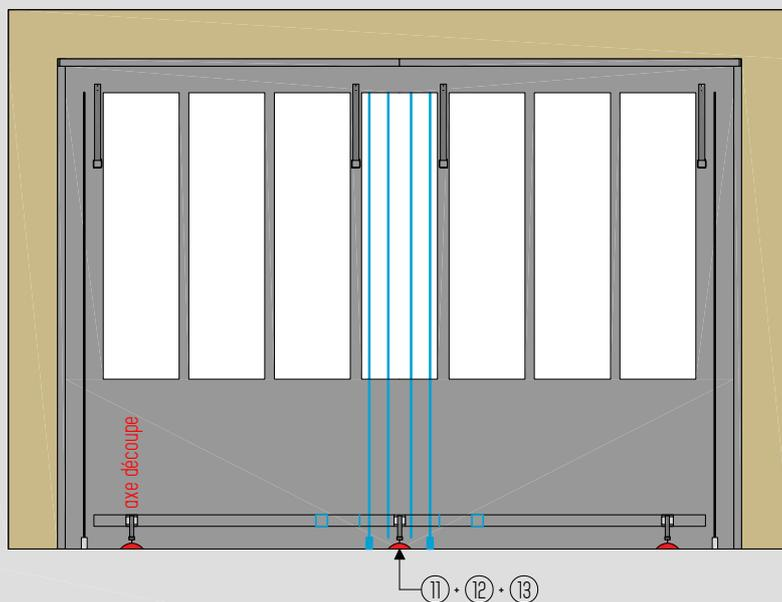
**J** MISE EN PLACE PLATINE ET PROFILS DU POTEAU
