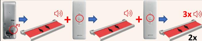
Pour arriver au **point d'arrêt intermédiaire**, on doit presser le bouton « Stop » pendant **2 secondes**.
