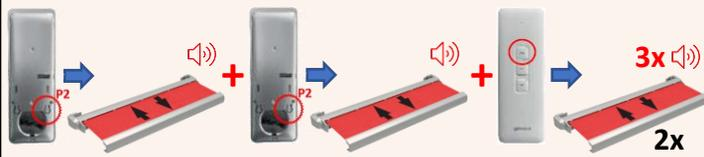
**Sens de rotation inversé:** Si le sens de rotation n'est pas le bon, **maintenir simultanément** les boutons « Montée + Descente » pendant 2 secondes puis presser le bouton « Descente » pour tester le sens de rotation.
